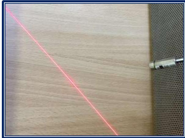
Лазерный диодный (полупроводниковый) модуль, излучающий в красной области спектра (650 нм), с разверткой точки в тонкую линию. Отличается малыми габаритами и настройкой фокуса. Применяется для разметки в деревообрабатывающей, строительной и других видах промышленности.
